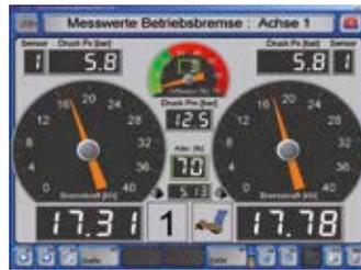
Während der Bremsprüfung werden alle relevanten Daten übersichtlich dargestellt.
